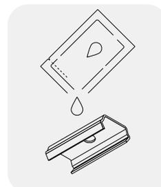
Lubrificare le clips (B) con grasso silconico in dotazione (E).
